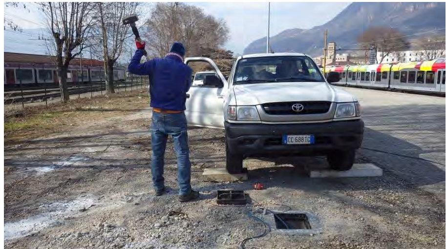
Energizzazione Onde S
