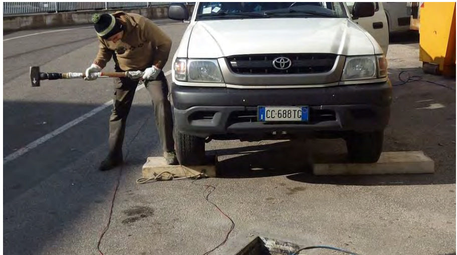
Energizzazione Onde S
