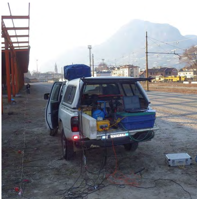
Stendimento sismico e attrezzatura di registrazione
