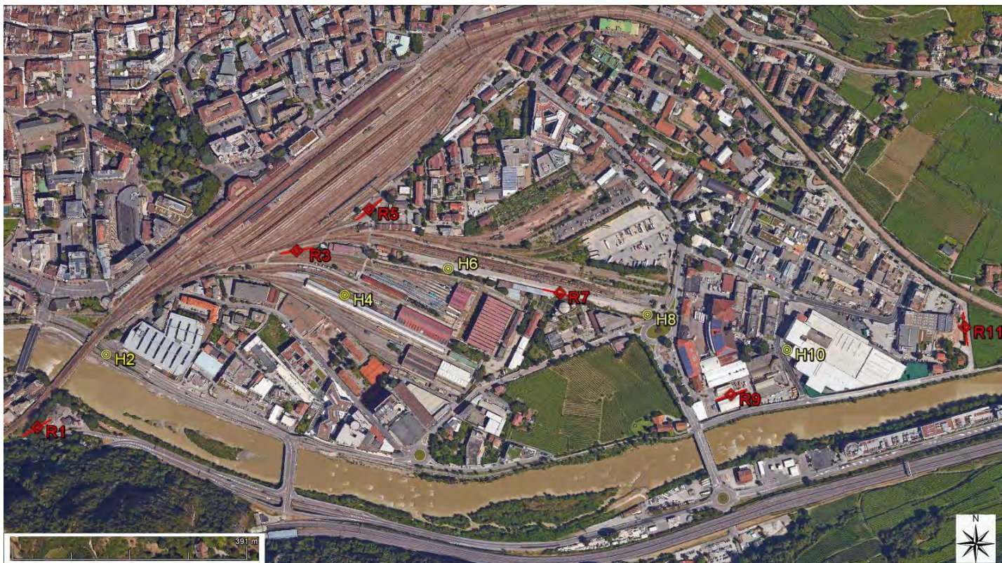
Fig. 1 – Ubicazione indagini (simbolo rosso MASW/Re.Mi. , giallo Down-Hole)
